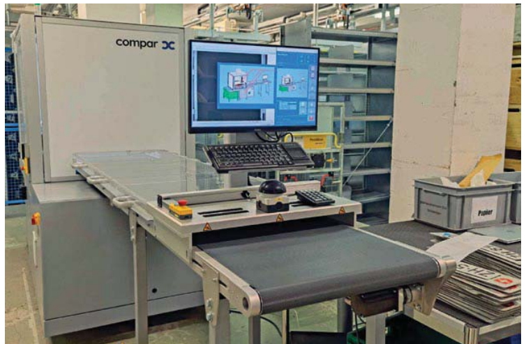
Die von Compar entwickelte Anlage: Vorne ist der Auflagebereich des Förderbandes mit Touchscreen-Bildschirm und Vorlaufstrecke. Im grauen Kasten befindet sich die Kamera. (Bild: Klaus Vollrath)
